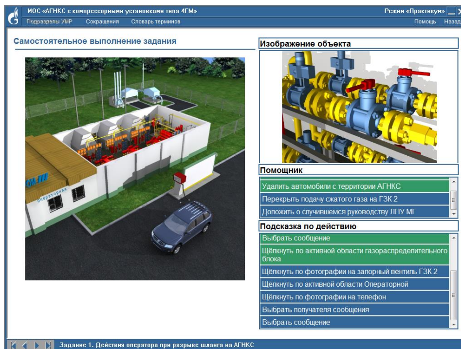
Рисунок 4. Интерактивное учебное задание «Действия оператора при разрыве шланга на АГНКС» (виртуальная модель оборудования)
